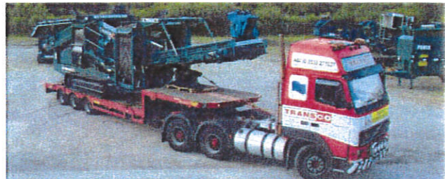
POWERSCREEN Warrior 1400 beim Tiefladertransport
